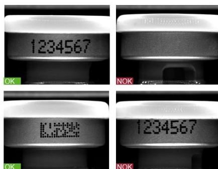
Abb. 6: vial.inspect liest verschiedenste 1D- und 2D-Codes und ermöglicht so eine lückenlose Rückverfolgbarkeit der Medikamente.
