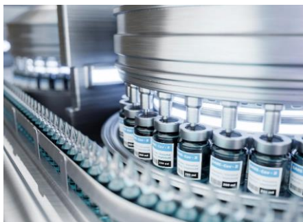
Abb.1: vial.inspect von OCTUM ermöglicht eine zuverlässige Prüfung von pharmazeutisch genutzten Phiolen vor und nach deren Abfüllung.
