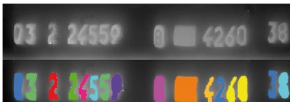
Die 3D-Rohdaten mit Höhendaten sind oben als Graubild codiert, unten die entsprechend segmentierten Zeichen
