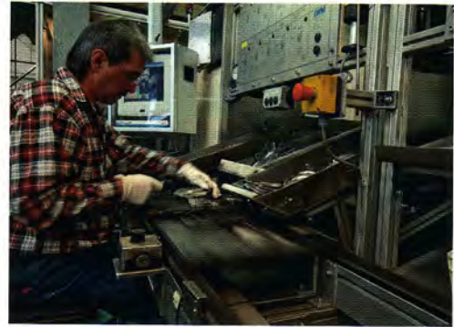
Im Viersekundentakt werden die Bauteile der Sitzbeschläge auf dem Werkstückträger eingelegt und durchlaufen die Prüfstation
