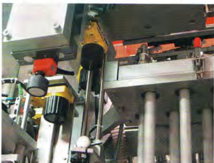
Zwei Kameras übernehmen bei der Partikelkontrolle den Tubengrund, die Schulter und die Innenseite der Tubenkappe ins Visier.
