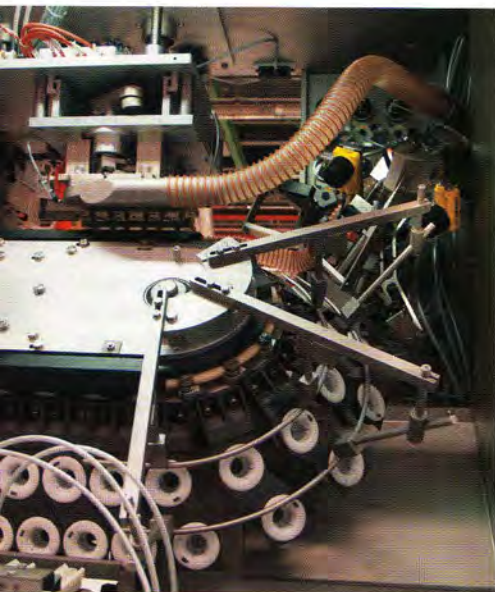
Zwei Kameras prüfen in der Trimmingstation die lückenlose Erkennung fehlerhafter Packmittel bezüglich richtiger Ausrichtung der Bedruckung und die korrekte Verarbeitung der Schweißnaht.
