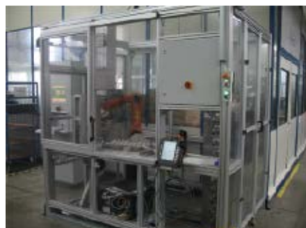
Abb. 8: Anlage zur automatischen Endkontrolle von Verdichterrädern
