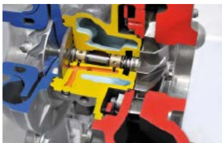
Abb. 1: Schematischer Aufbau eines Abgas-Turboladers mit Verdichterrad
